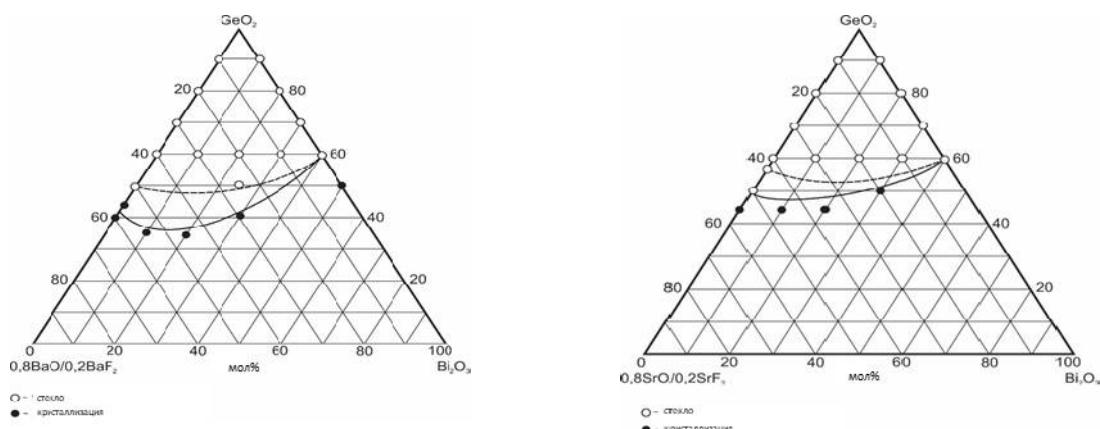
Рисунок 1. Области стеклообразования и область устойчивых к кристаллизации стекол систем  $\text{GeO}_2\text{-}\text{Bi}_2\text{O}_3\text{-}0.8\text{SrO}/0.2\text{SrF}_2$  и  $\text{GeO}_2\text{-}\text{Bi}_2\text{O}_3\text{-}0.8\text{BaO}/0.2\text{BaF}_2$
