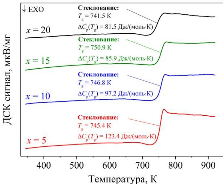
Рисунок 1. Кривые ДСК стекол  $20\text{Bi}_2\text{O}_3-(80-x)\text{B}_2\text{O}_3-x\text{BaO}$  ( $x = 5, 10, 15, 20$  мольн.%) при скорости нагрева 5 град/мин.
