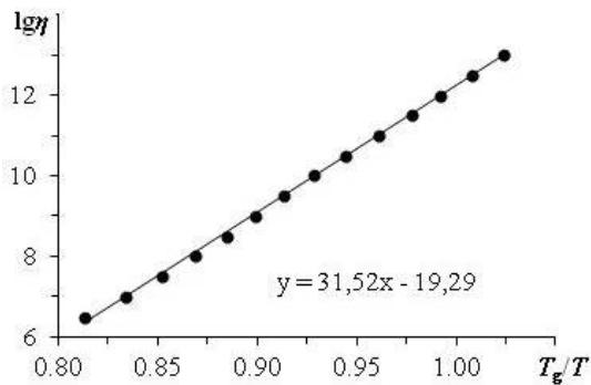
Рисунок. 1. Определение фрагильности  $m$  для стекла Sb-Ge-Se с применением метода наименьших квадратов.
