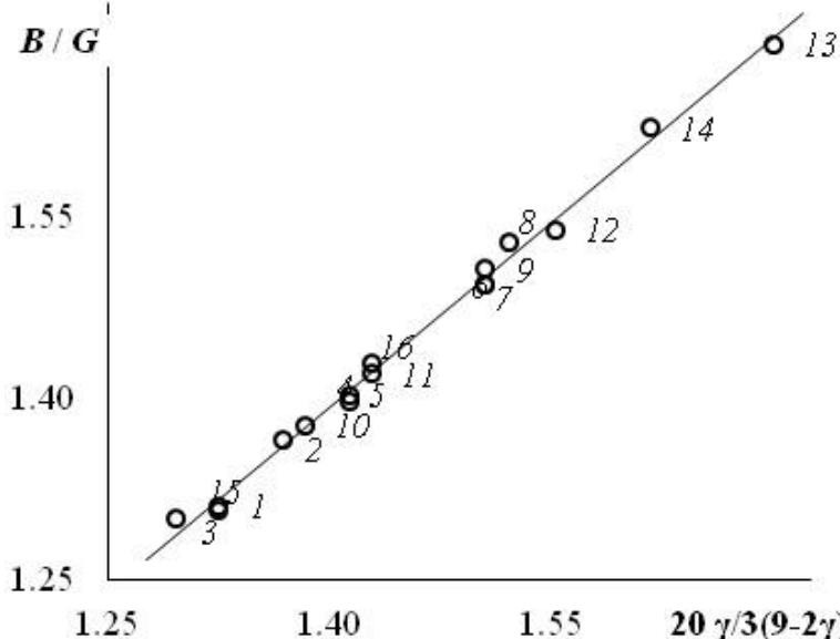
Рисунок 1. Зависимость отношения упругих модулей ( $B/G$ ) от функции параметра  $\gamma$  по соотношению (4). Двух- и трехкомпонентные стекла  $\text{Na}_2\text{O} - \text{Al}_2\text{O}_3 - \text{SiO}_2$  с разным мол. % окислов в составе. Нумерация составов на рисунке совпадает с нумерацией в таблице.
