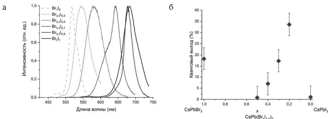
Рисунок. 1. (а) Спектры люминесценции стеклокерамик с перовскитными нанокристаллами, полученными после термообработки при 470 °C в течение 1 ч. (б) Зависимость квантового выхода этих стеклокерамик от молярного соотношения галогенов в нанокристаллах. Длина волны возбуждения в обоих случаях 410 нм.
