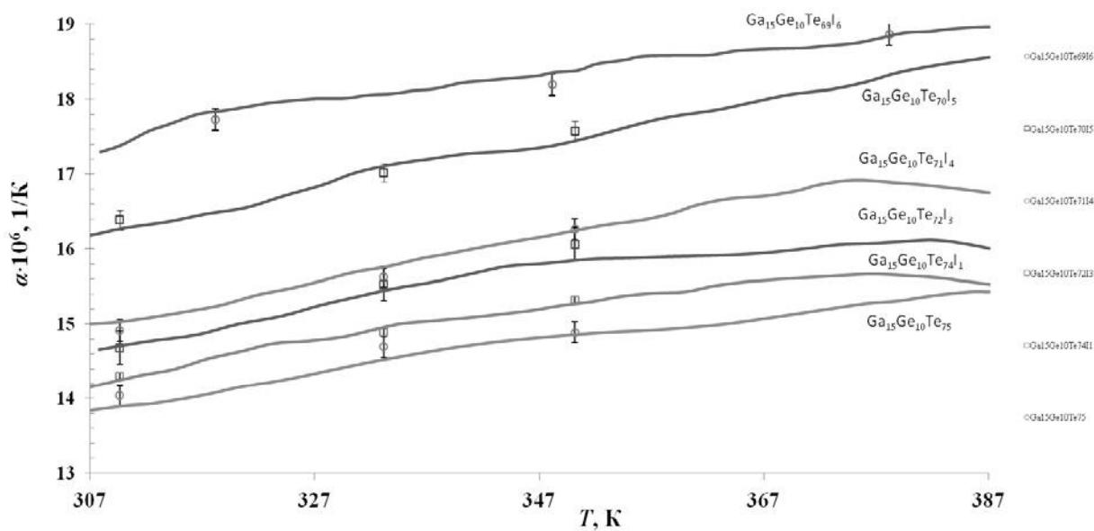
Рисунок 1. Температурная зависимость КЛТР стёкол  $\text{Ga}_{15}\text{Ge}_{10}\text{Te}_{75-x}\text{I}_x$  ( $x = 0 - 6$  at. %)
