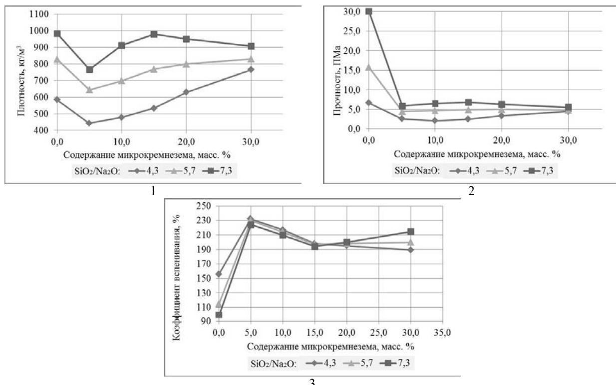
Рисунок 1. Зависимости свойств пористого стеклокомпозита на основе маршалита от содержания микрокремнезема, для  $\text{SiO}_2/\text{Na}_2\text{O}=4,3-7,3$ : 1 – плотности,  $\text{kg}/\text{m}^3$ ; 2 – прочности, МПа; 3 – коэффициента вспенивания, %.
