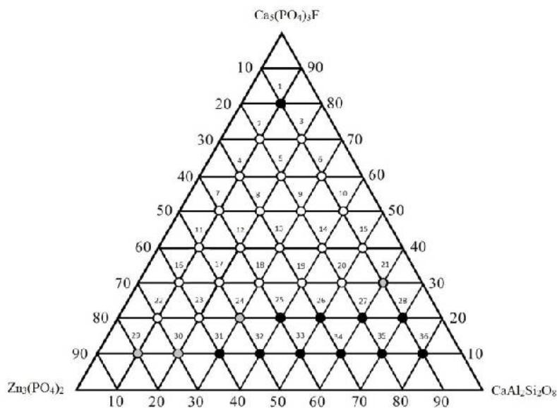
Рисунок 1. Область стеклообразования в системе  $Zn_3(PO_4)_2$ – $Ca_5(PO_4)_3F$ – $CaAl_2Si_2O_8$ .
