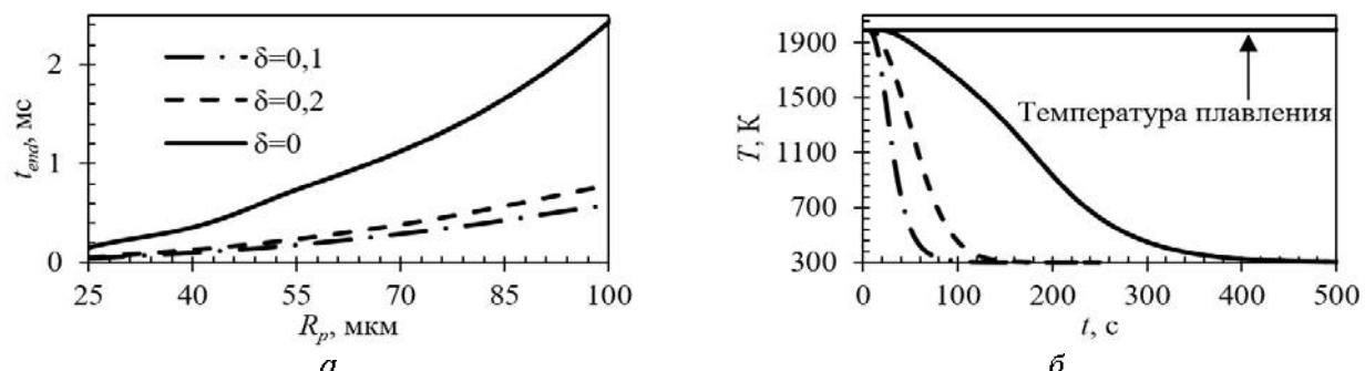
Рисунок 1. Зависимости времени завершения процесса охлаждения частицы  $\text{SiO}_2$  до температуры 300 К от радиуса частицы при различной толщине оболочки  $\delta = 0; 0,1$  и  $0,2$  (а) и динамика изменения температуры в центре полой частицы  $\text{SiO}_2$  для случая  $R_d=50$  мкм (б)
