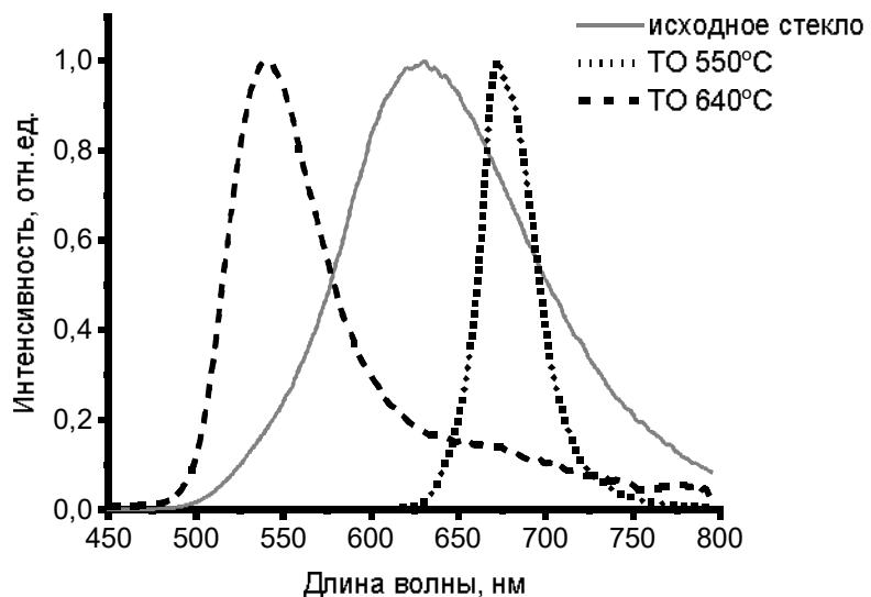
Рисунок 1. Спектры люминесценции исходного литий-цинк-германатного стекла, активированного ионами марганца, и стеклокерамик, полученных при различных температурах термообработки.
