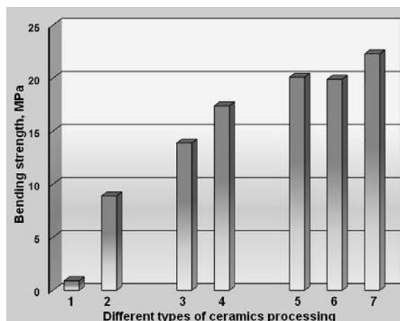
Рисунок. 1. Результаты испытаний механической прочности кварцевой керамики: 1 - исходный образец керамики; 2 - керамика, обработанная золем; 3 - исходная керамика после ТО (1200 °C, 1 ч); 4 - исходная керамика после ТО (1200 °C, 1 ч + 600 °C, 2 ч); 5,6,7 - керамика, обработанная золями с различным соотношением компонентов;
