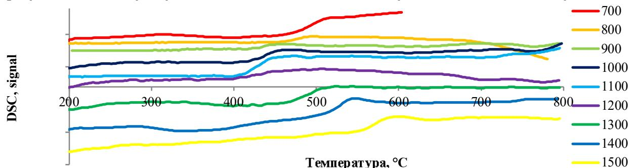
Рисунок. 2. Термограммы образцов стеклокерамик  $\text{BaO}-\text{B}_2\text{O}_3-\text{Bi}_2\text{O}_3-\text{Er:YAG}$ , полученных методом горячей пропитки из смеси стекла  $\text{BaO}-\text{B}_2\text{O}_3-\text{Bi}_2\text{O}_3$  и сформированного граната  $\text{Er:YAG}$  в разных температурных режимах от  $700$  до  $1500^\circ\text{C}$ .
