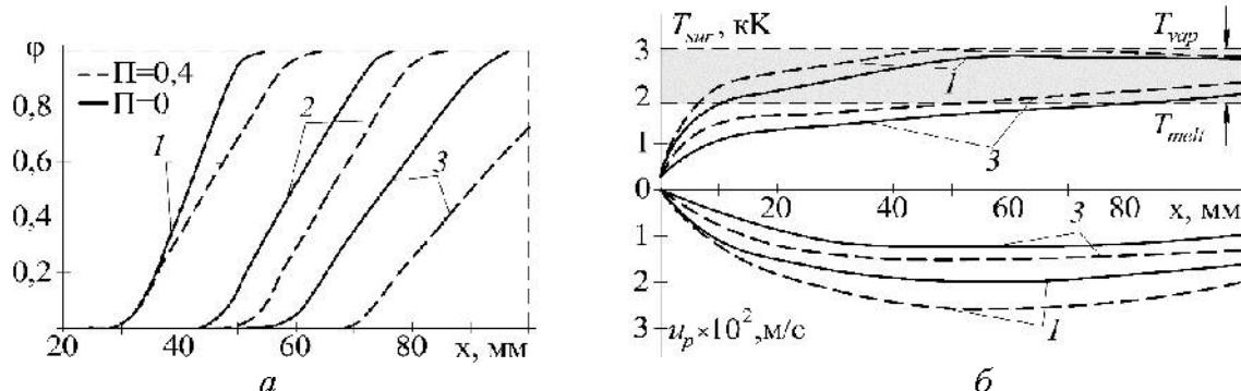
Рисунок 1. Зависимость динамики движения, нагрева и плавления агломерированной частицы  $\alpha\text{-SiO}_2$  пористостью  $\Pi=0$  и  $\Pi=0,4$  от координаты вдоль оси  $x$ :  $a$  – доля расплавленной массы частицы;  $b$  – температура поверхности и скорость частицы. 1 –  $D_{p0}=50$  мкм; 2 – 100 мкм; 3 – 150 мкм
