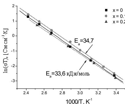
Рисунок. 1. Температурная зависимость проводимости в координатах Аррениуса
