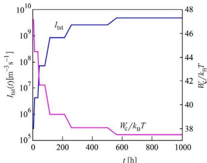
Рисунок. 2. Зависимости работы образования критического зародыша  $W_c$  и стационарной скорости зарождения кристаллов  $I_{\text{st}}$  в стекле  $\text{Li}_2\text{O}\cdot 2\text{SiO}_2$  от времени термообработки при  $T = 703\text{K}$  ( $k_{\text{B}}$  – постоянная Больцмана).
