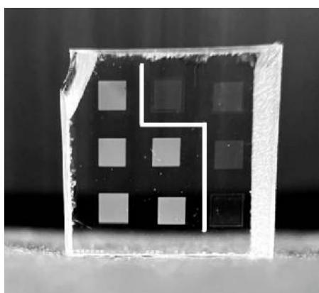
Рисунок 1. Записанные лазерным пучком фазовые оптические элементы, представленные одним слоем модификаций типа II (слева от белой линии) и несколькими слоями модификаций типа X (справа от белой линии). Фазовая задержка записанных оптических элементов составляет от 140 до 170 нм.
