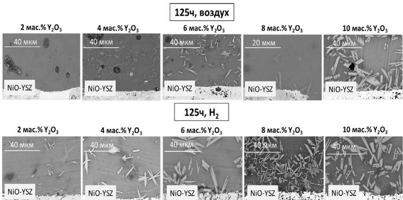
Рисунок 1. Микрофотографии соединений стекло|NiO-YSZ после выдержки в течении 125 ч при температуре 850 °C на воздухе и в восстановительной атмосфере
