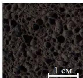
Рисунок 1. Макроструктура геополимерного материала на основе топливного шлака.
