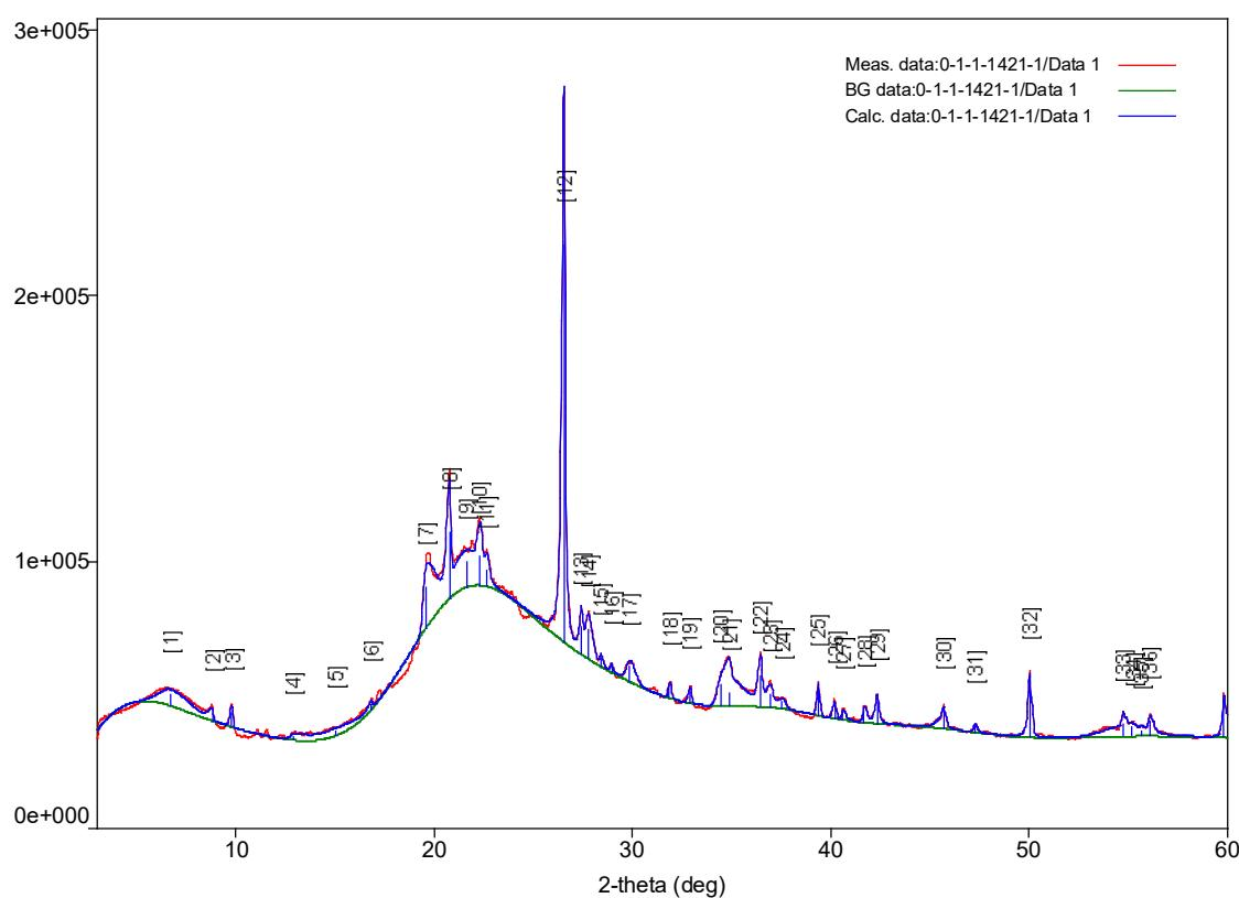
Рисунок. 1. Рентгенофазовый анализ пробы диатомита
