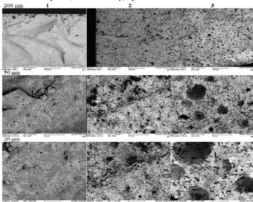
Рисунок. 3. Микрофотографии образцов стеклокерамики  $20\text{Bi}_2\text{O}_3-65\text{B}_2\text{O}_3-15\text{BaO}-\text{Er:YAG}$ , полученных в различных режимах термообработки: 1 –  $T = 700^\circ\text{C}$ , 2 –  $T = 1100^\circ\text{C}$ , 3 –  $T = 1250^\circ\text{C}$  (по вертикали).
