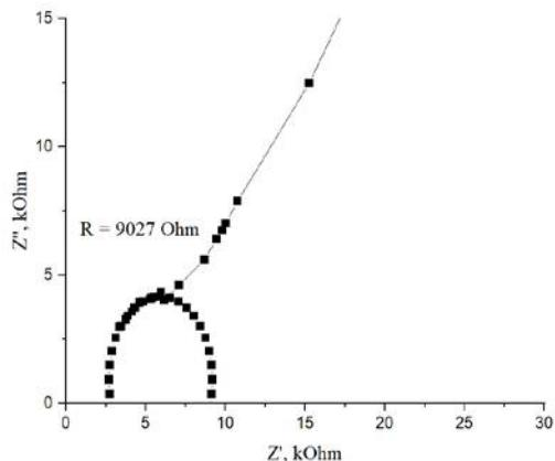
Рисунок. 2. График Коула-Коула состава 2.5GeS<sub>2</sub>-27.5Sb<sub>2</sub>S<sub>3</sub>-70AgI при комнатной температуре.
