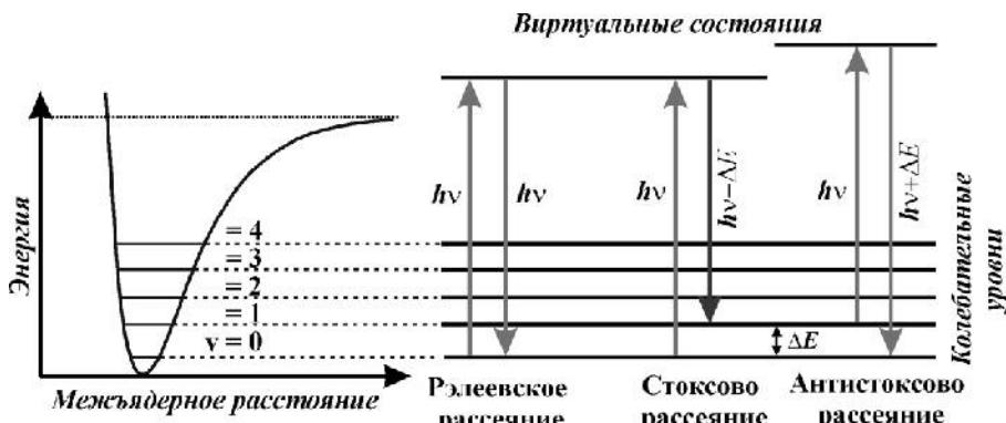
Рисунок 1. Иллюстрация явления спонтанного комбинационного рассеяния света.
