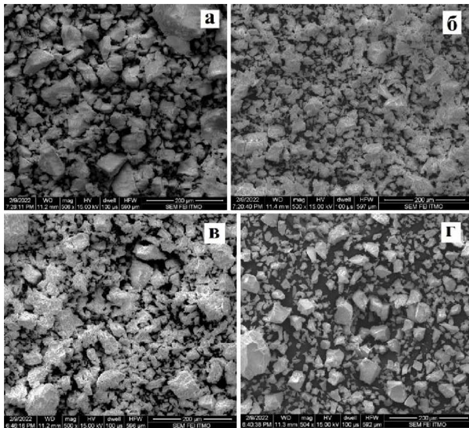
Рисунок 1. Микрофотографии (СЭМ) порошков в системах ZrO<sub>2</sub>–CeO<sub>2</sub> (а), ZrO<sub>2</sub>–Y<sub>2</sub>O<sub>3</sub> (б), ZrO<sub>2</sub>–Yb<sub>2</sub>O<sub>3</sub> (в), ZrO<sub>2</sub>–Gd<sub>2</sub>O<sub>3</sub> (г)
