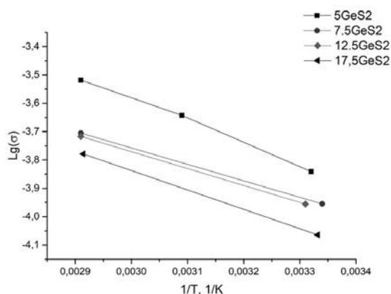
Рисунок. 3. Температурная зависимость логарифма удельной ионной проводимости стекол.
