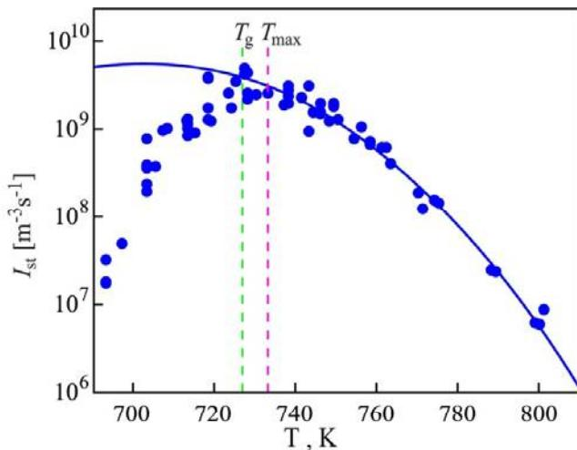
Рисунок. 1. Показана экспериментально измеренная стационарная скорость зарождения кристаллов  $I_{\text{st}}$  в стекле состава дисиликата лития,  $\text{Li}_2\text{O}\cdot 2\text{SiO}_2$ , в зависимости от температуры (кружки). Сплошная линия показывает теоретически предсказанную стационарную скорость нуклеации [1].
