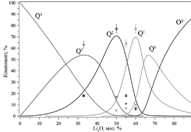
Рисунок. 1. Моделирование  $Q^n$  – распределения системы  $\text{Li}_2\text{O}-\text{SiO}_2$ .
