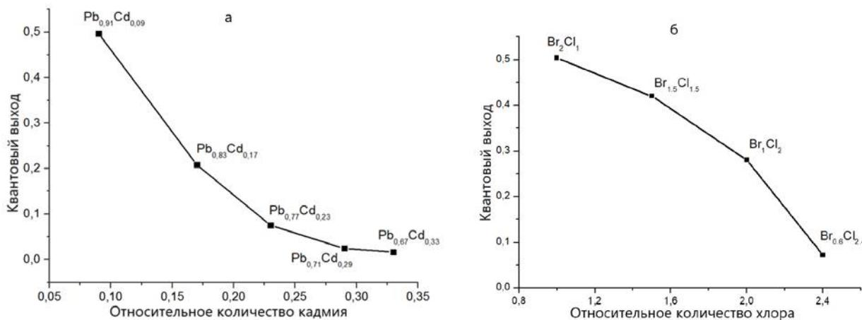
Рисунок 1. Квантовый выход для стекол с нанокристаллами  $CsPb_{1-x}Cd_xBr_3$  (а) и  $CsPb_{3-x}Cl_x$  (б)
