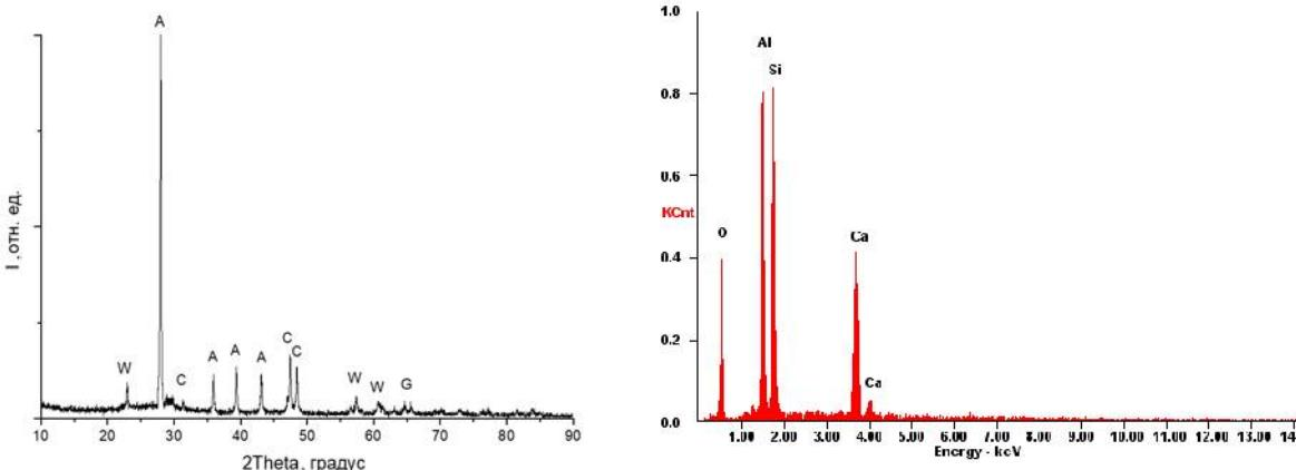
Рисунок 1. Результаты рентгеновской дифрактометрии и энергодисперсионного анализа синтезированного образца аортитовой керамики
