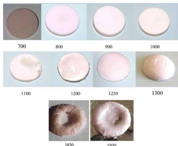
Рисунок. 1. Фотографии образцов стеклокерамик BaO–B<sub>2</sub>O<sub>3</sub>–Bi<sub>2</sub>O<sub>3</sub> – Er:YAG, полученных методом горячей пропитки в разных температурных режимах от 700 до 1500 °C.
