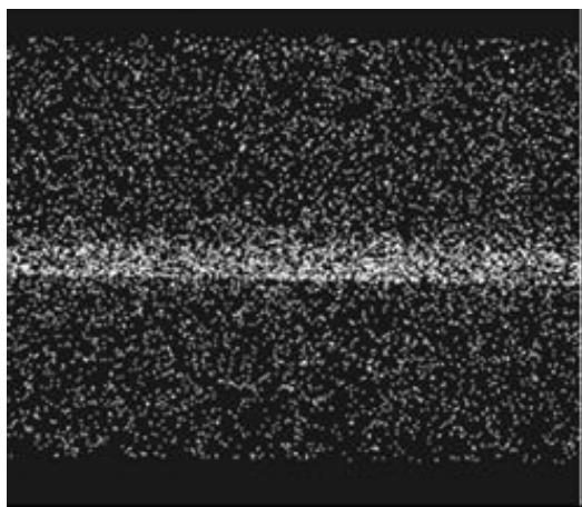
Рисунок. 1. Распределение Bi по толщине (1 мм) мембранны МАП- $\text{Bi}_2\text{O}_3$ .
