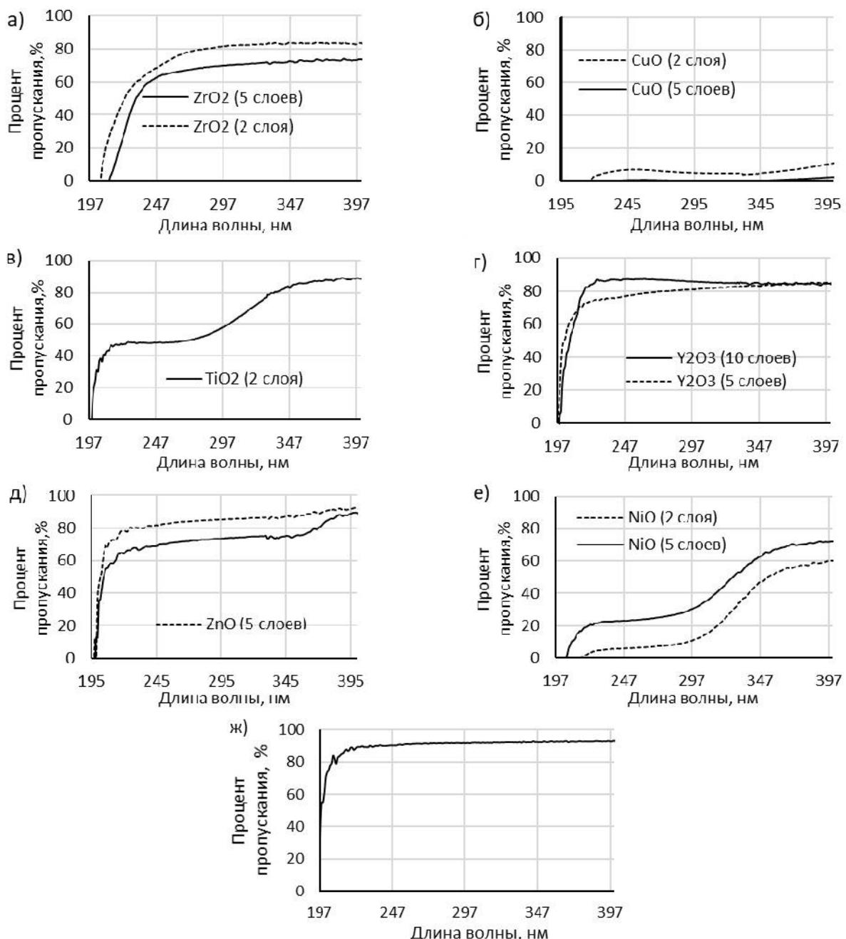
Рисунок. 1. УФ-спектры образцов с покрытиями ZrO<sub>2</sub> (а), CuO (б), TiO<sub>2</sub>, (в), Y<sub>2</sub>O<sub>3</sub> (г), ZnO (д) и NiO (е) в сравнении со спектром исходной подложки кварцевого стекла (ж)
