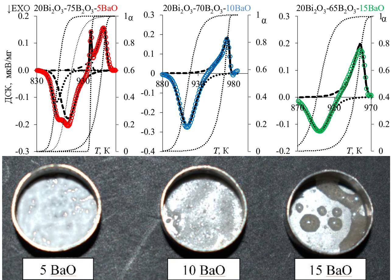
Рисунок. 1. ДСК сигнал (символы) при скорости нагревания 5 К/мин. Линии – расчет. Ниже, фотографии образцов стекол  $20\text{Bi}_2\text{O}_3-(80-x)\text{B}_2\text{O}_3-x\text{BaO}$  ( $x = 5, 10, 15$  моль% $)$  после ДСК исследования в платиновых тиглях по окончании температурной программы (нагрев со скоростью 10 град/мин до температуры 1000 К и последующее охлаждение со скоростью не более 15 град/мин).
