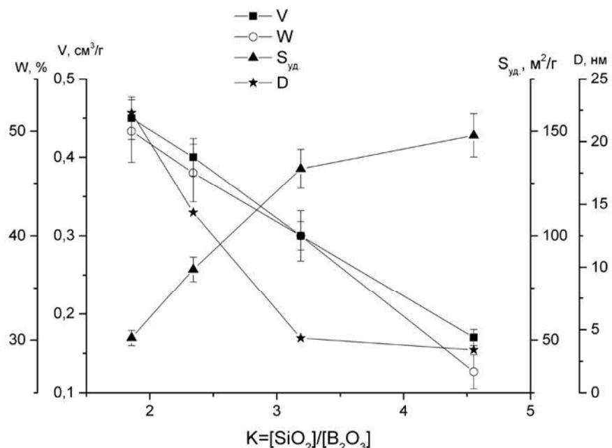
Рисунок 1. Зависимости параметров порового пространства полученных ПС от молярного соотношения K=[SiO<sub>2</sub>]/[B<sub>2</sub>O<sub>3</sub>].
